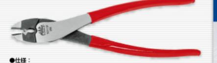
全長 245mm、 カシメ対応径 22AWG(外径 0.64mm)~10AWG(外径 2.6mm)、 カッターは鋼とアルミニウムのみ切断可能
